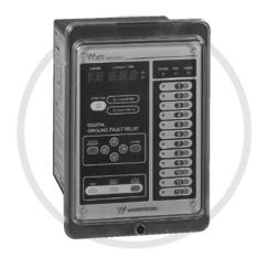
본 계전기는 KSC8328에 준거하여 제작된 누전(지락)계전기로 Digital 방식을 채택하여 고신뢰성과 고기능의 회로로 구성되었다. 일반산업용에 경지락, 중지락등 광범위한 기능설정이 가능하고 KEPCO, 지하철, 공장, 빌딩, Plant등의 선로에 사용되는 AGFR입니다. 또한 기존의 방식보다 1회로, 12회로로 구성되어 설계 시방시 호환되도록 선택범위가 넓고 기존에 사용되는방식은 보조계전기함(BOX)을 사용하였으나 외부의 CB,MCCB등과 직접연결(Direct)하여 사용할수 있도록 특수 설계 고안된 제품으로 약20%정도의 원가절감 효과가 있고 영상 변류기(ZCT)와 조합 구성되어 동작되는 경보용 및 차단기 트립 겸용으로도 사용되는 계전기 입니다.
